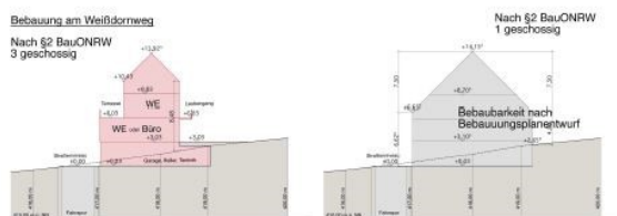
Gewünschte Bauform - Erbengemeinschaft Schenk - Gebäudetyp IV - Hausgruppen Bezogen auf Straßenniveau 0,00 m Traufhöhe bergseits 8,48 m Traufhöhe talseits 10,43 m Firsthöhe 13,92 m
