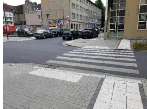
Abb. 21: FGÜ mit barrierefreier Gestaltung (Doppelquerung)
