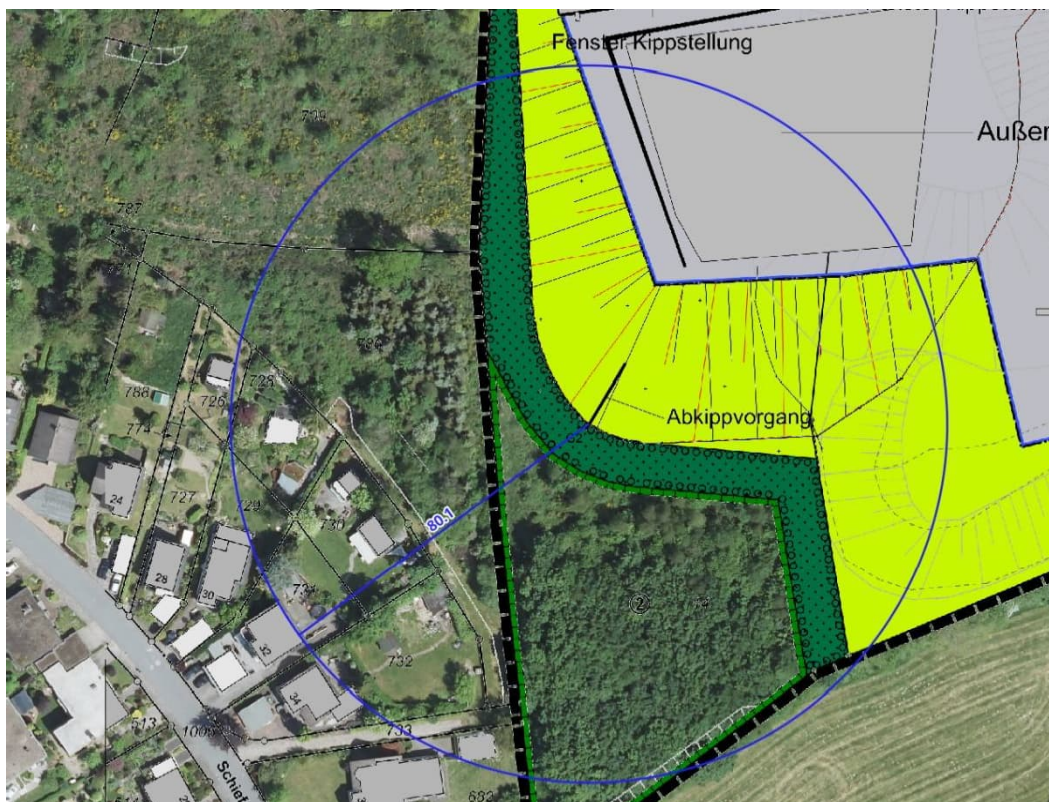
Abbildung 7.1: Zukünftiger Abstand Haldenfuß – Bestandsbebauung (Quellen: Bebauungsplan: Stadt Schmallenberg; Ö.b.V.l. Markus Schulte; Luftbild: Geobasis NRW, Datenlizenz Deutschland – Zero – Version 2.0 – http://www.govdata.de/dl-de/zero-2-0 )
